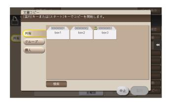
設定説明[検索]ボックスの検索に使います。ボックス登録時に指定した検索文字別にボックスが表示されます。<br/>テンキーで直接ボックス番号を指定することもできます。数字の入力エリアをタップするとテンキーを表示します。
