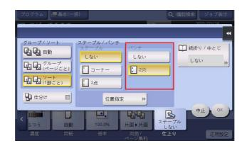
設定説明[位置指定]パンチ位置と原稿のセット方向を選びます。パンチ位置を [自動] に設定すると、セットした原稿の方向からパンチ位置を自動的に決定します。
