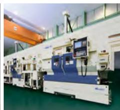
平行2軸型CNC旋盤 &
