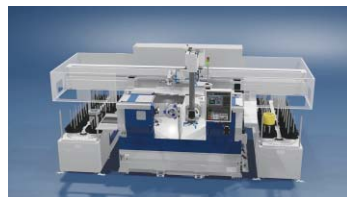
旋削加工と搬送装置の動作をCGアニメーションで可視化
