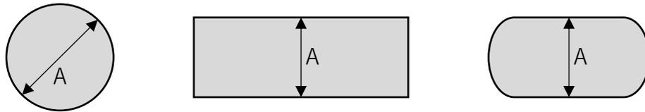
軟鋼、アルミ :  $A \geq t$  (板厚以上)
