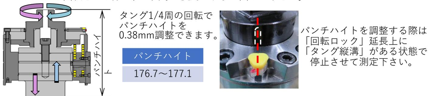
4、タンク回転ロックをロック状態にしストリッパを取り付けます。
