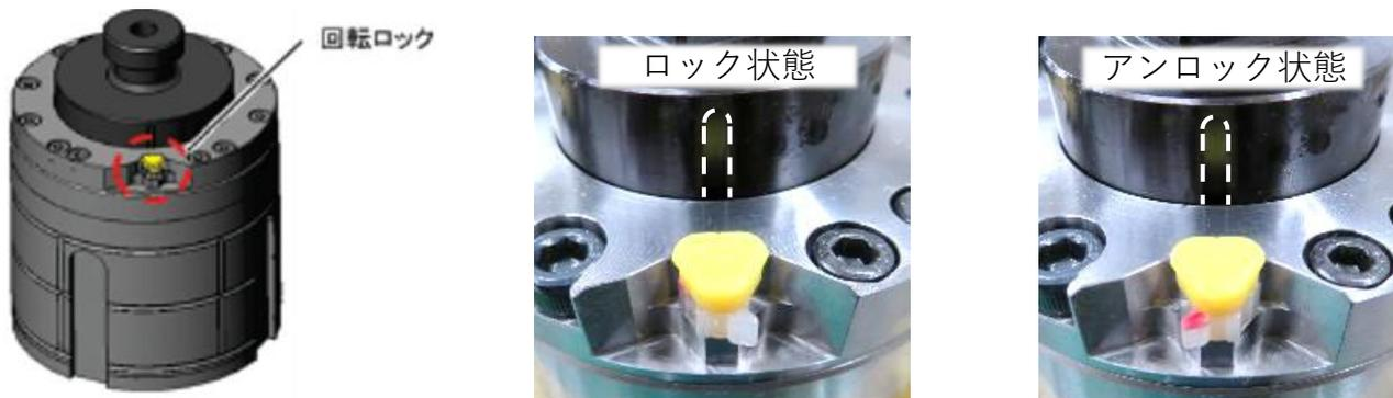
2、パンチホルダにパンチを挿入し、吊ボルトを締め付けてパンチを締結します。
