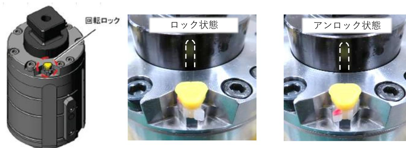
2、パンチホルダにパンチを挿入しタングを回転させてパンチ高さを調整します。タングを回転させる際は、工具等は使用せず手で回して下さい。
