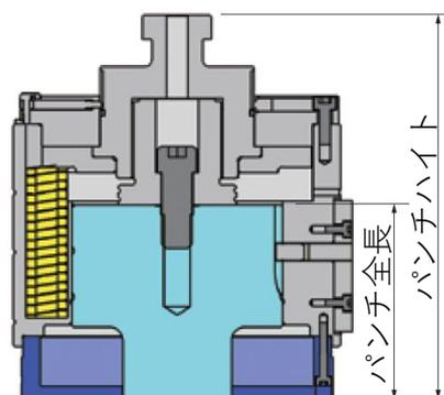
標準メタルストリッパとパンチ刃先端の段差 1 mmがパンチ高さの目安になります。
