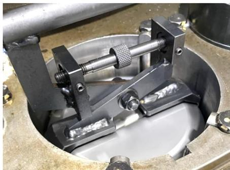
金型のキー溝（金型裏面）をダイホルダのキー位置に合せ
