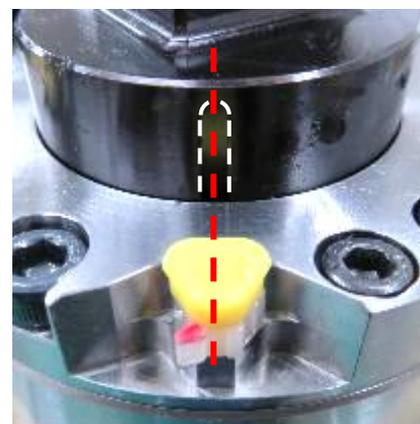
3、タング回転ロックをロック状態にし、ストリッパを取り付けます。
