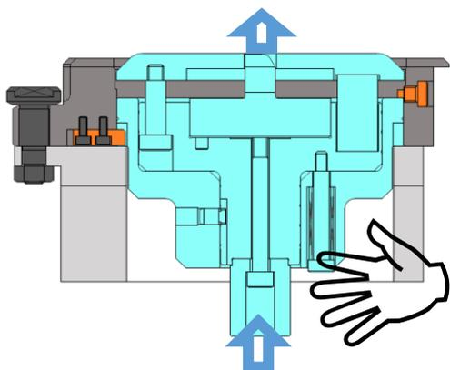
セットネジを固定したらプッシャーを手で押し上げ、
