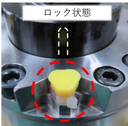
注) 必ず回転ロックがロック状態になっていることを確認してからタレットにセットして下さい。アンロック状態のままタレットにセットした場合、タレット回転時にパンチホルダタングがラムと衝突し、機械が故障します。
