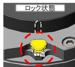
注) 必ず回転ロックがロック状態になっていることを確認してからタレットにセットして下さい。
